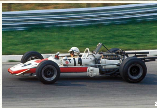
1 2 4 エンジン搭載方法に加え、前進したシート位置などでスタイリングも独創的だったRA302。1 フランスGPでの1号車に対し、2 イタリアGPでTカーとして予選に登場した2号車はノーズフィンやロールバー後方にオイルクーラーが増設されていた。3 120度のVバンクと8気筒。すべて自然空冷実現のためのスペックだった。
