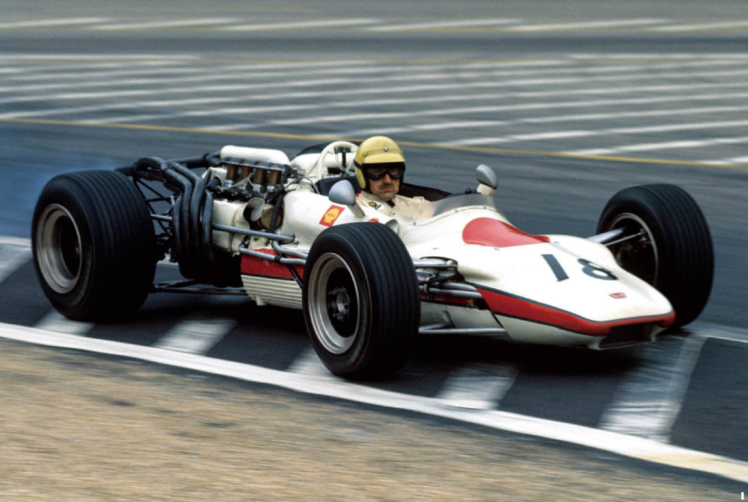
1 2 4 エンジン搭載方法に加え、前進したシート位置などでスタイリングも独創的だったRA302。1 フランスGPでの1号車に対し、2 イタリアGPでTカーとして予選に登場した2号車はノーズフィンやロールバー後方にオイルクーラーが増設されていた。3 120度のVバンクと8気筒。すべて自然空冷実現のためのスペックだった。
