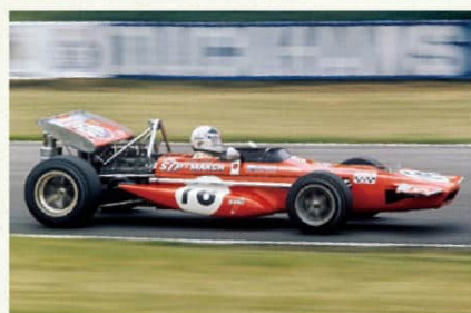
1970年のマーチ701は、ボディ両サイドに翼断面形状の補助燃料タンクを装着。発案者のピーター・ライトはのちにロータスでウイングカーを開発することになる。
