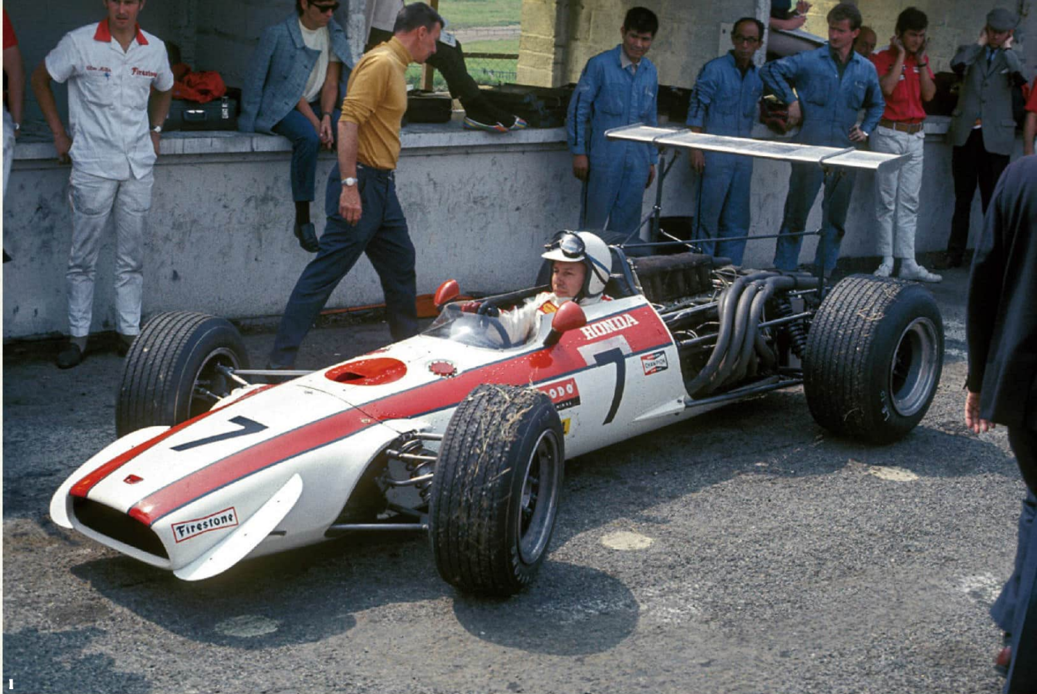
1 ローラとの共闘体制2年目の68年。第2戦スペインGPより登場した新車は“流用”ではなく、新設計のエンジン、RA301Eに合わせて開発された車両だった。車重は大幅に軽量化され、RA300から60kgも軽かった。2 第3戦のモナコGPでは予選4位からトップを窺い、3 第9戦のイタリアGPではポールから発進も勝利は飾れず。
