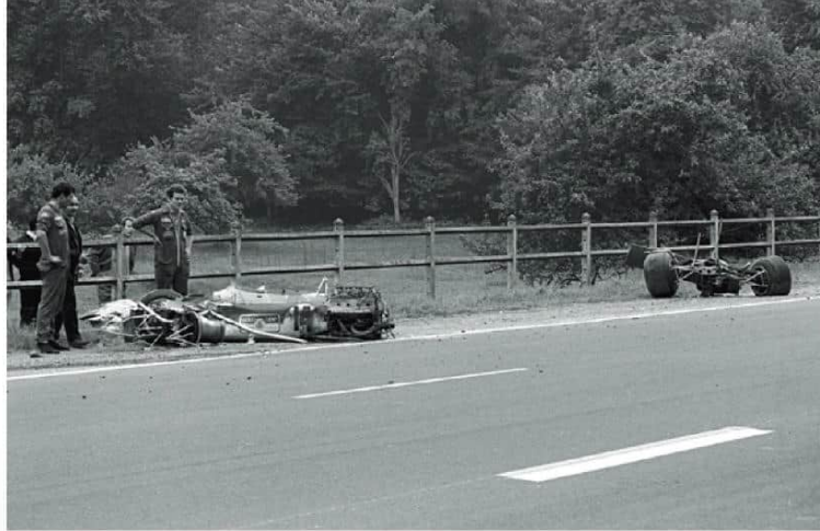
エンジンをストレスメンバーとして使うロータス49Bは時々こうなります、と冗談を言えるのも、J.オリバーが無事だったからこそ。68年フランスGP予選で。
