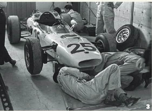
1 ドイツGP登場の“初号機”。決勝はバックナムの手で最後尾からの特別出走に。2 モノコック+後部スペースフレームという独特な構造のシャシーに横置きで1.5ℓながらV12というRA271Eが収まる。RA271Eは2戦目のイタリアGPからインジェクション仕様となった。3 3戦目のアメリカGPでは、フロントカウル下にオイルクーラーが追加された。
