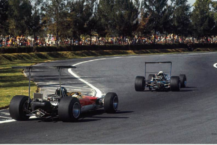
DFV登場の翌年、1968年シーズンからはウイングが大流行。瞬く間にハイマウント化し、脱落事故も多発したことから69年シーズン早々に禁止となるも、空力追求の動きが止まることはなかった。
