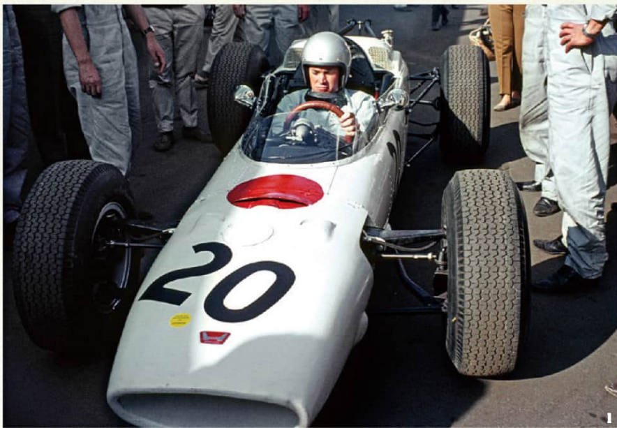
1 ドイツGP登場の“初号機”。決勝はバックナムの手で最後尾からの特別出走に。2 モノコック+後部スペースフレームという独特な構造のシャシーに横置きで1.5ℓながらV12というRA271Eが収まる。RA271Eは2戦目のイタリアGPからインジェクション仕様となった。3 3戦目のアメリカGPでは、フロントカウル下にオイルクーラーが追加された。
