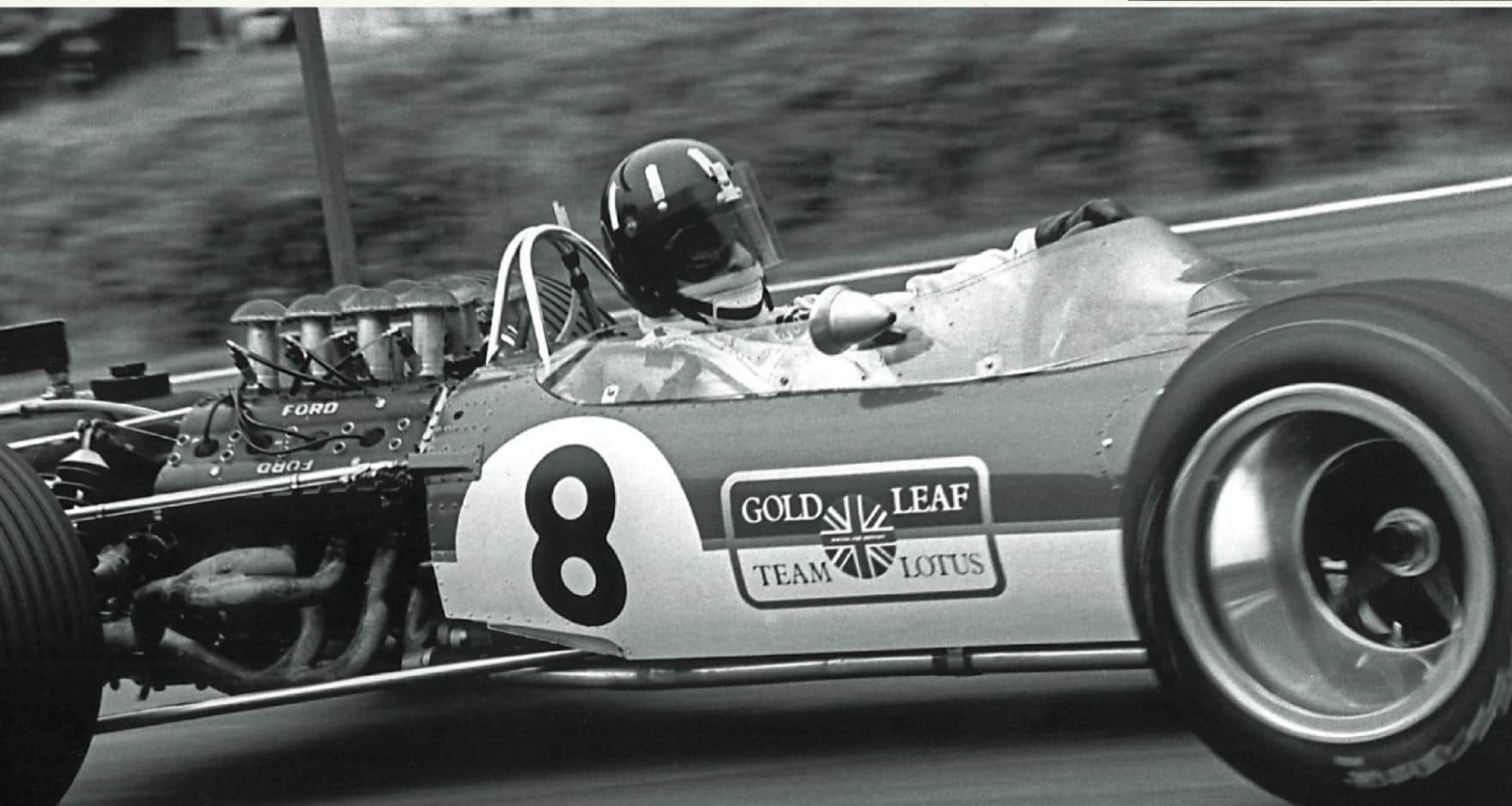
壊れにくく、軽量コンバクト。そんなDFVはロータスのシャシーと組み合わせられ、68年にはグラハム・ヒルとともにF1を制す。すると瞬く間に他チームへと伝播。DFVは一部の12気筒勢などを除く、多数のチームへ供給されるベストセラーに。
